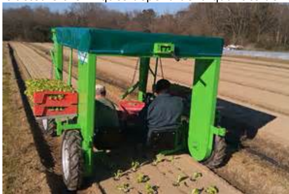
Plateforme électrique pour la plantation de salades
