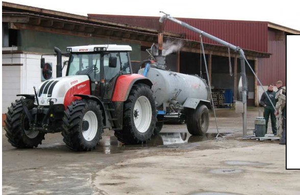
Pompage du digestat depuis le post-digesteur pour épandage
